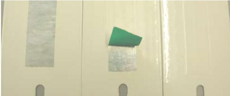
Bild 1 – Probekörper mit abgeklebten Bereichen zur Vermeidung der Ritzanbringung
