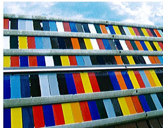
Zur Überprüfung der Wetterbeständigkeit werden Proben der Beschichtungsmaterialien bis zu 5 Jahren in Florida ausgelagert.
