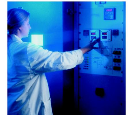
Bewitterungsprüfung im Global UV-Gerät. Dieser Laborversuch simuliert das Bewitterungsverhalten über größere Zeiträume.
