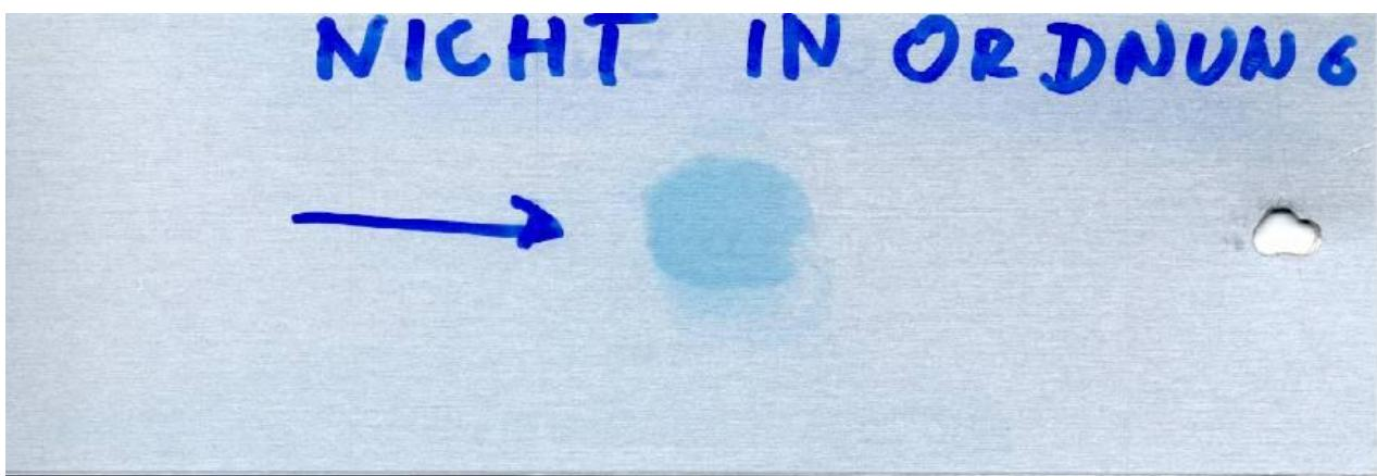
Als Referenz für eine „offenporige“ Oxidschicht kann ein Musterabschnitt, der vor dem Einwirken der Testlösung mit einem Tropfen der Säurelösung behandelt und sorgfältig mit vollentsalztem Wasser (VE-Wasser) gespült wurde, herangezogen werden.
